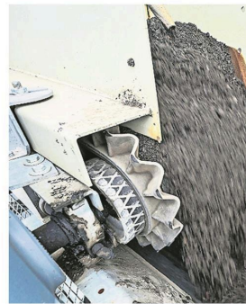
Recyclingmaterial aus dem Straßenbau wird auf das Förderband einer Asphaltmischanlage transportiert. Foto: Deck/dpa
